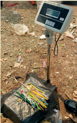
ภาพที่ ข-2 การหาความหนาแน่น (Bulk Density) ของตัวอย่างขยะมูลฝอย
