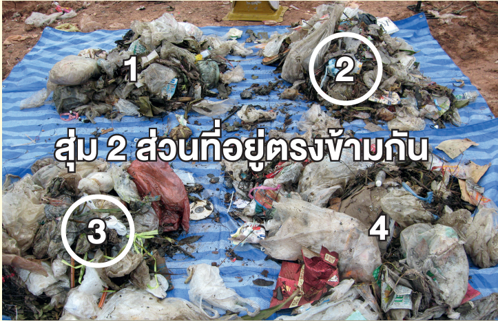
ภาพที่ ข-1 การแบ่งขยะมูลฝอยออกเป็น 4 ส่วน (Quartering) และเลือกส่วนเอามา 2 ส่วน ที่อยู่ตรงข้ามกัน
