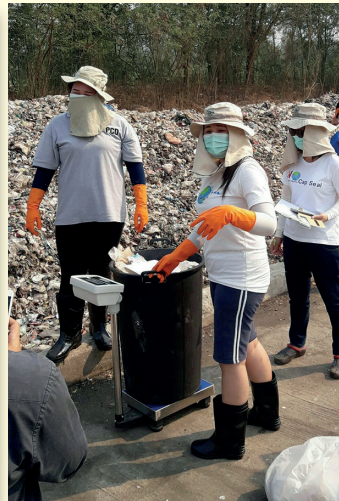
ภาพที่ ข-2 การหาความหนาแน่น (Bulk Density) ของตัวอย่างขยะมูลฝอย
